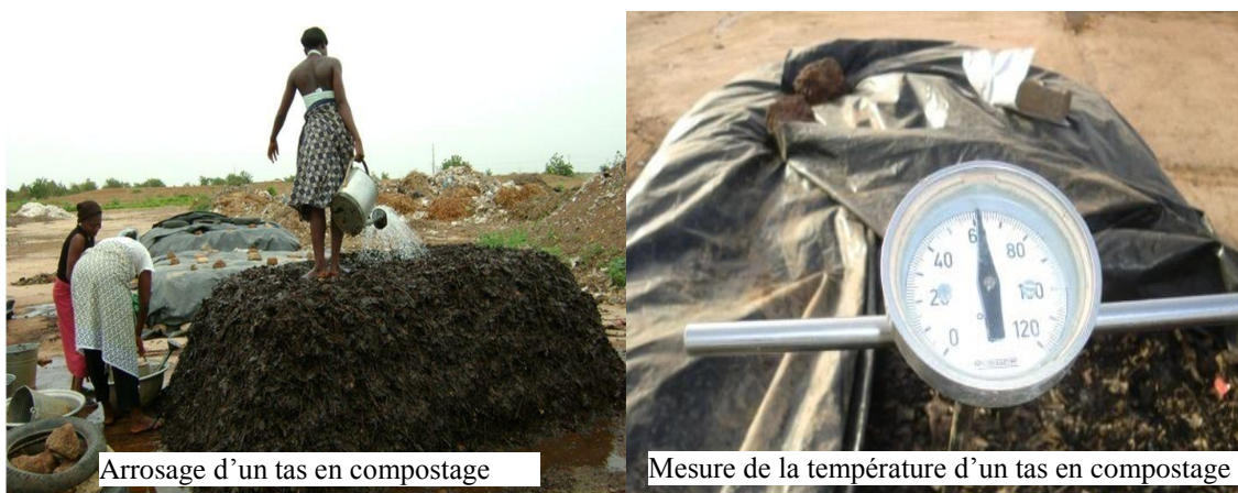
Figure 3. Illustration de l'arrosage et de mesure de la température d'un tas en compostage
